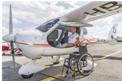
↑ Die sehr leichten ecolight-Flugzeuge wurden mit speziellen Bedienelementen ausgestattet, mit denen sich die Pedale des Flugzeugs manuell steuern lassen.
